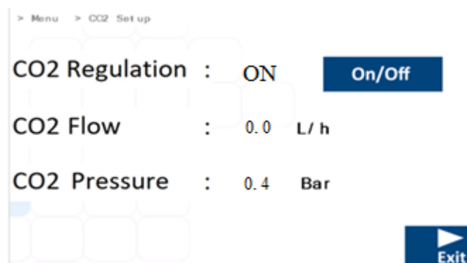
Εικόνα 13.25 Υπομενού ρύθμισης CO 2 επωαστήρων εξωσωματικής γονιμοποίησης πολλαπλών θαλάμων MIRI® TL6 και MIRI® TL12
