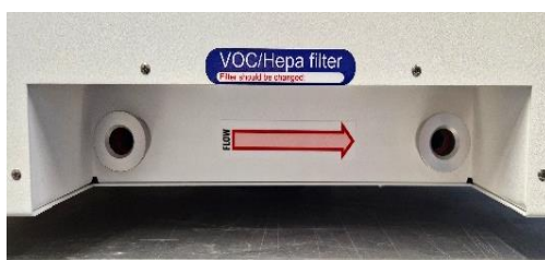
Εικόνα 12.1 Βέλος κατεύθυνσης στους επωαστήρες εξωσωματικής γονιμοποίησης πολλαπλών θαλάμων MIRI® TL6 και MIRI® TL12
