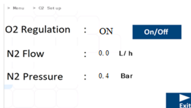
Εικόνα 13.26 πομενού ρύθμισης O 2 επωαστήρων εξωσωματικής γονιμοποίησης πολλαπλών θαλάμων MIRI® TL6 και MIRI® TL12
