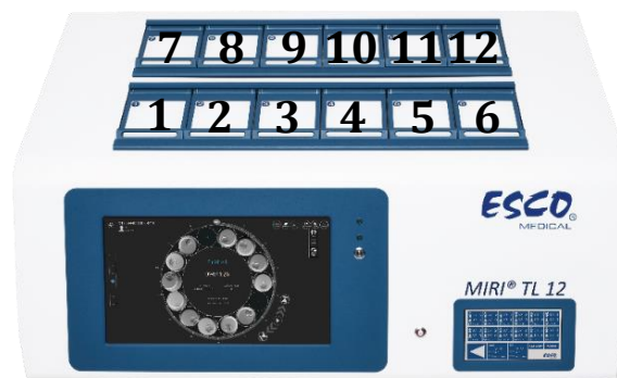
Εικόνα 7.2 Αριθμοί θαλάμων επάνω στον επωαστήρα εξωσωματικής γονιμοποίησης πολλαπλών θαλάμων MIRI® TL12
