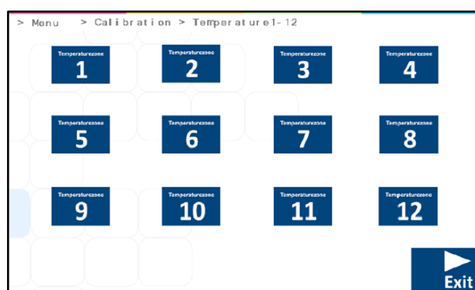
Πίνακας 13.19 12 ζώνες βαθμονόμησης στον επωαστήρα εξωσωματικής γονιμοποίησης πολλαπλών θαλάμων MIRI® TL6
