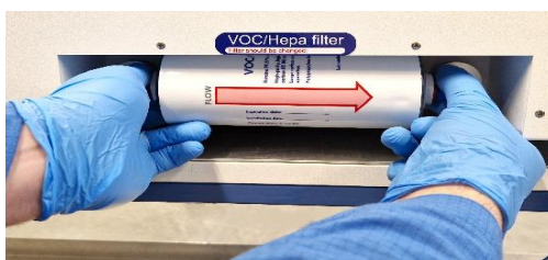
Εικόνα 12.2 Διαδικασία εισαγωγής και αφαίρεσης φίλτρου VOC/HEPA
