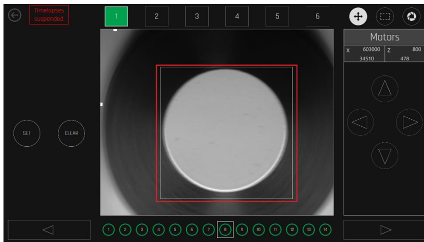
Εικόνα 20.30 Θέση φρεατίου μέσα στο επισημασμένο τετράγωνο όριο
