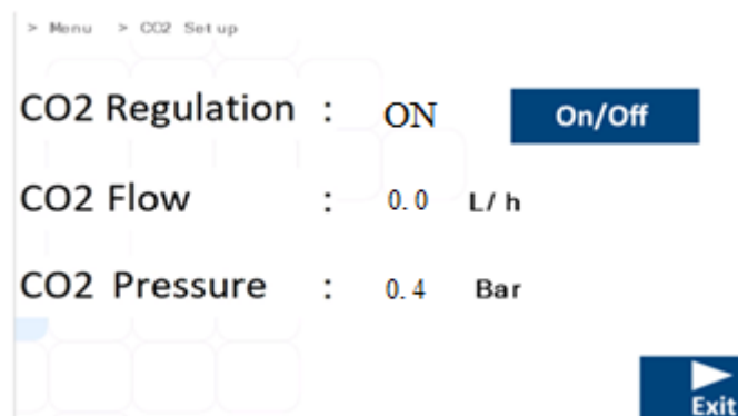
Εικόνα 16.2 Υπομενού ρύθμισης CO 2 επωαστήρων εξωσωματικής γονιμοποίησης πολλαπλών θαλάμων MIRI® TL6 και MIRI® TL12
